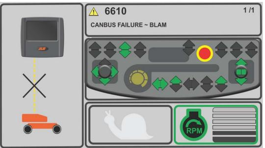
Figure 5-9. CAN Bus Lost Screen
